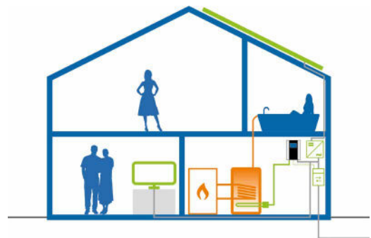
Photovoltaische Warmwasserbereitung bis 9 kW.
