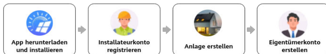
Abbildung 7-1 Bereitstellen einer neuen Anlage
