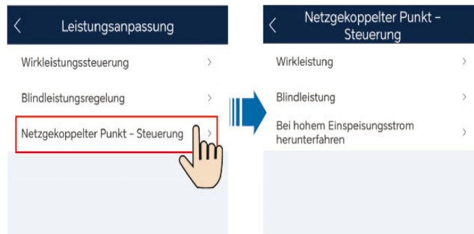
Abbildung 7-7 Netzgekoppelter Punkt – Steuerung
