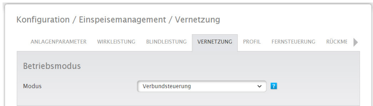
Abb.: Aktivierte Verbundsteuerung
