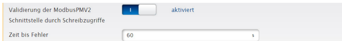
Abb.: Mit aktivierter „Validierung der ModbusPMV2 Schnittstelle durch Schreibzugriffe“
