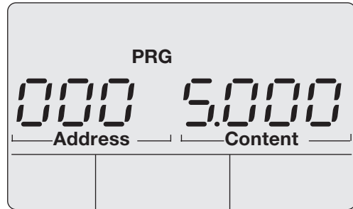
Abb.20.1 Anzeigenbeispiel „Programmier-Modus“, Adresse 000 mit dem Inhalt 5.000.
