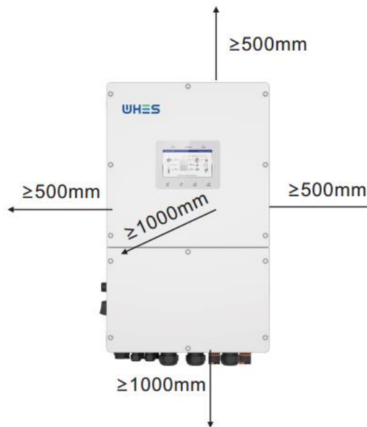
Abbildung 3.5 Montageabstände des Wechselrichters
