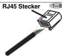
Abbildung 3.21 Isolierschicht abisolieren und an RJ45-Stecker anschließen
